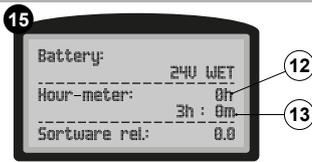
Attraverso il display di controllo, nella schermata dopo l'accensione, è possibile visionare nella parte centrale della schermata (Fig.15), le ore di lavoro effettuate dalla macchina. Nella prima riga si può leggere il tempo totale di utilizzo della macchina (12) e nella seconda riga viene visualizzato il tempo parziale di utilizzo della macchina (13).
